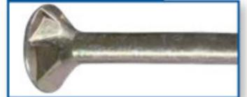
Die Frästaschen versenken den Kopf ausbruchsfrei und plan im Holz. Optimal auch für Beschläge und beschichtetes Holz. ttap®Antrieb ist auch mit TOR-Antrieb verschraubbar.
