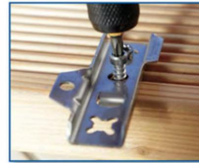
Einfach den REFIX-Dielenverbinder mit dem integrierten Montageanschlag auf die Rückseite der Diele legen und die beigegepackten Systemschrauben eindrehen.
