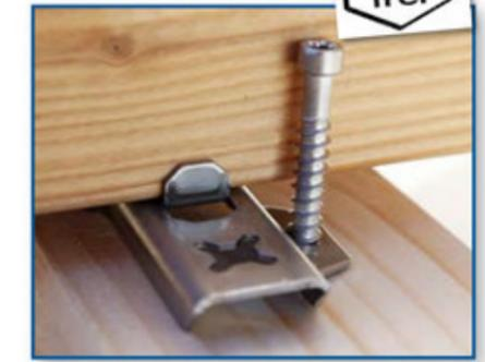
Danach die Diele an der Unterkonstruktion mit den ebenfalls beigegepackten Systemschrauben (35 mm Länge) befestigen. Bei der Anfangsdiele kann der REFIX-Dielenverbinder einfach horizontal um 180 Grad gedreht und der integrierte Montageanschlag flach gedrückt werden.
