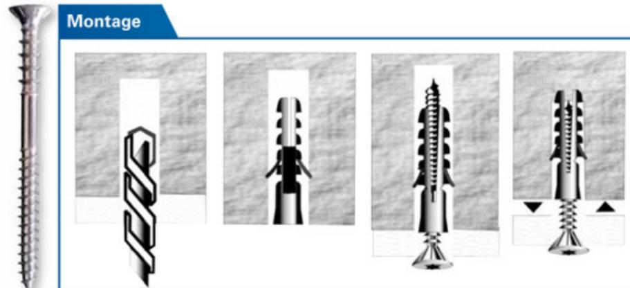
1. 5 mm Loch durch die Latte in das Mauerwerk bohren.
